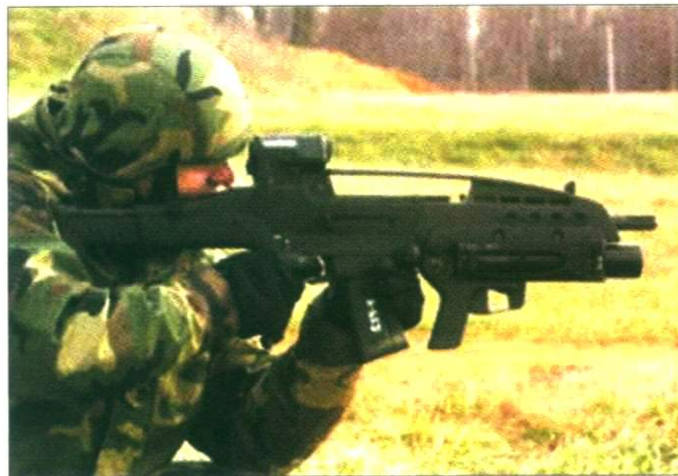
40-мм подствольный гранатомет XM320
