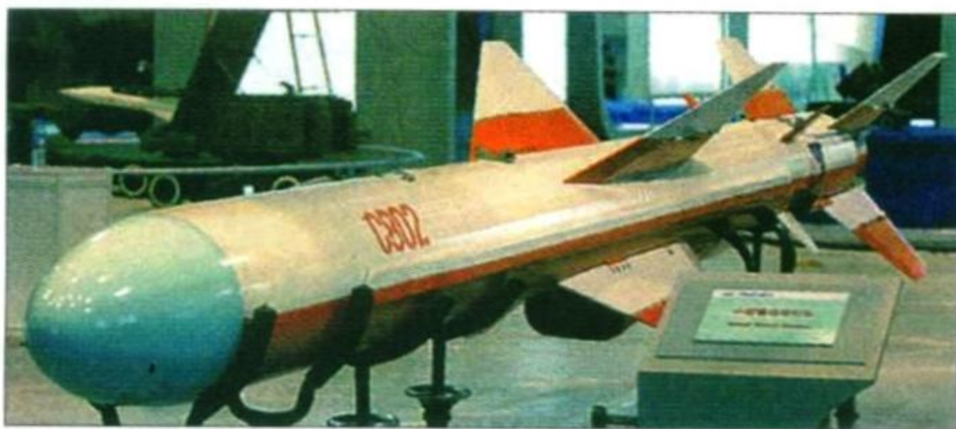
Китайская противокорабельная ракета YJ-82 (C-802)
