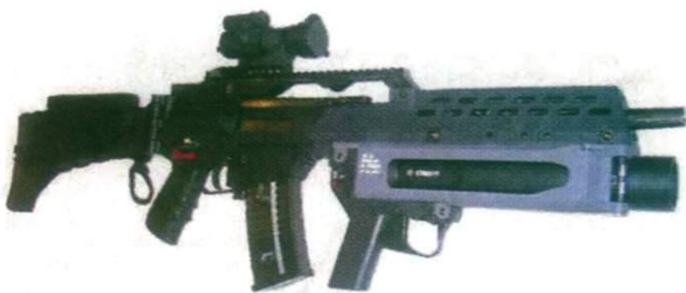
40-мм подствольный гранатомет AG36
