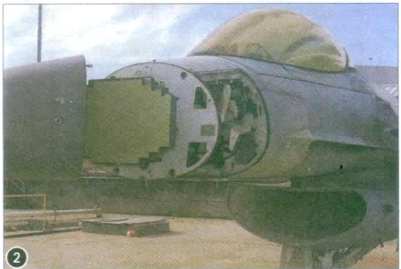
Радиолокационные станции с АФАР, предлагаемые к установке на тактических истребителях F-16C и D Block 40, 50 и 52 «Файтинг Фалкон»: 1 – РАКР фирмы «Рейтеон»; 2 – САБР фирмы «Нортроп-Грумман»
