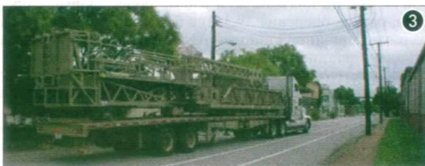
Основные элементы комплекса наземного оборудования аэростатной системы на базе аэростатов 32М/38М: 1 – общий состав; 2 – швартовочная система в развернутом положении; 3 – швартовочная система в транспортном положении
