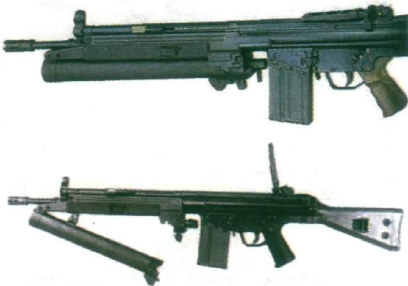
40-мм подствольный гранатомет НК79: А – общий вид; Б – в положении для зарядки
