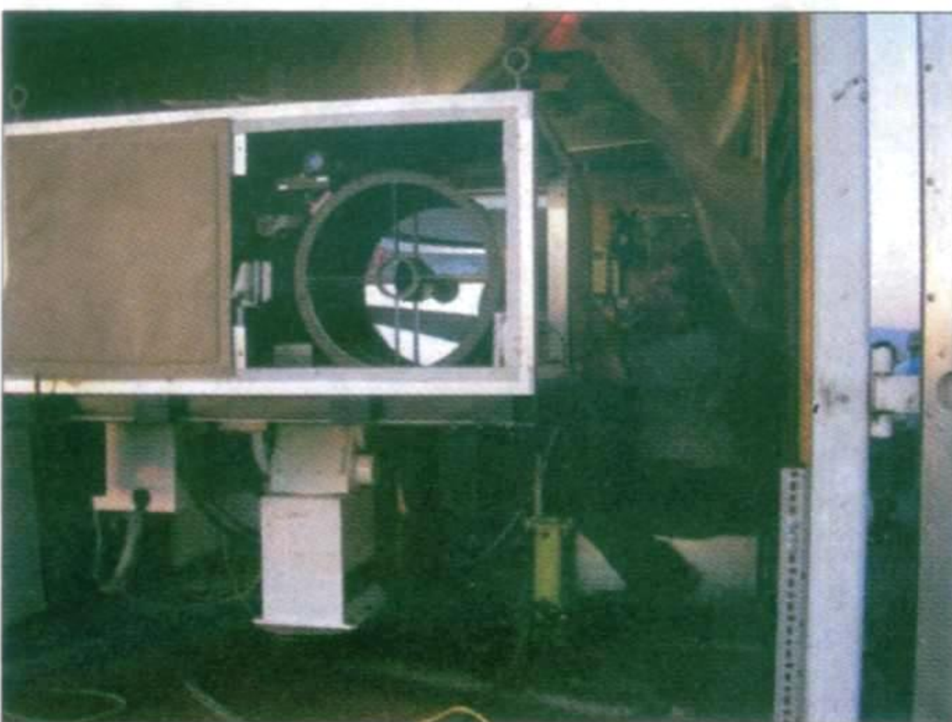
Экспериментальный многочастотный ИК-лидар, разработанный Эджвудским центром химической и биологической защиты сухопутных войск США
