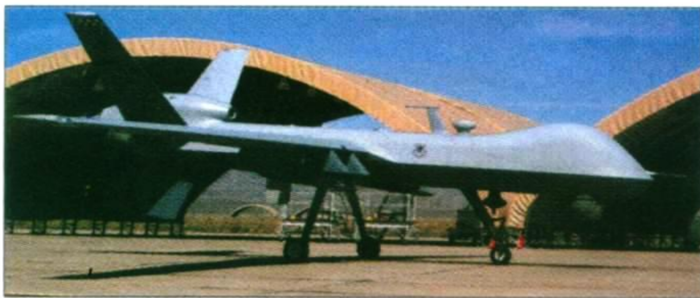
Стратегический разведывательный ДУЛА MQ-9 «Рипер»
