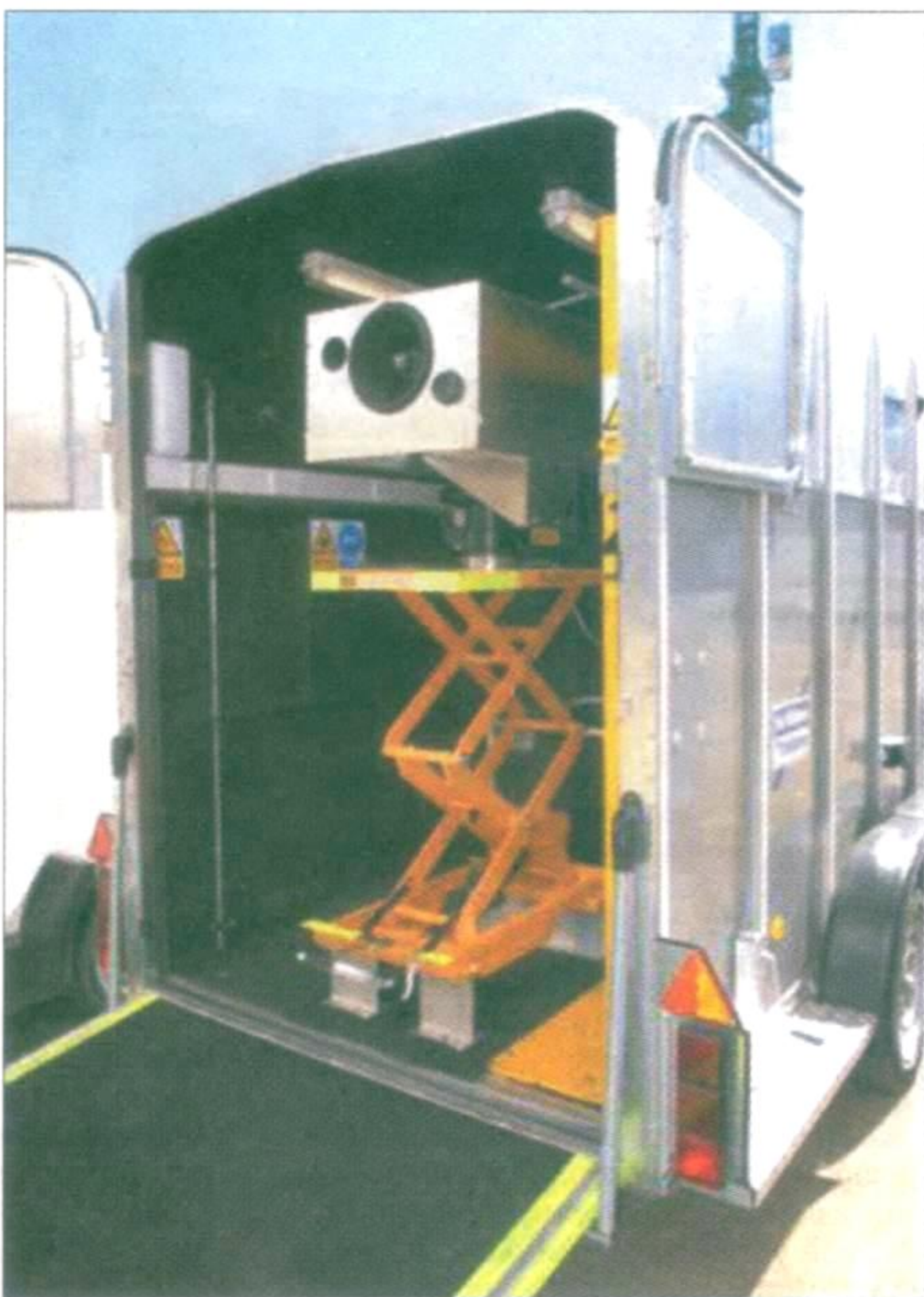
Комбинированный (ИК-УФ) лазерный комплекс биологической разведки, разработанный научно-технической лабораторией МО Великобритании (Портон-Даун)
