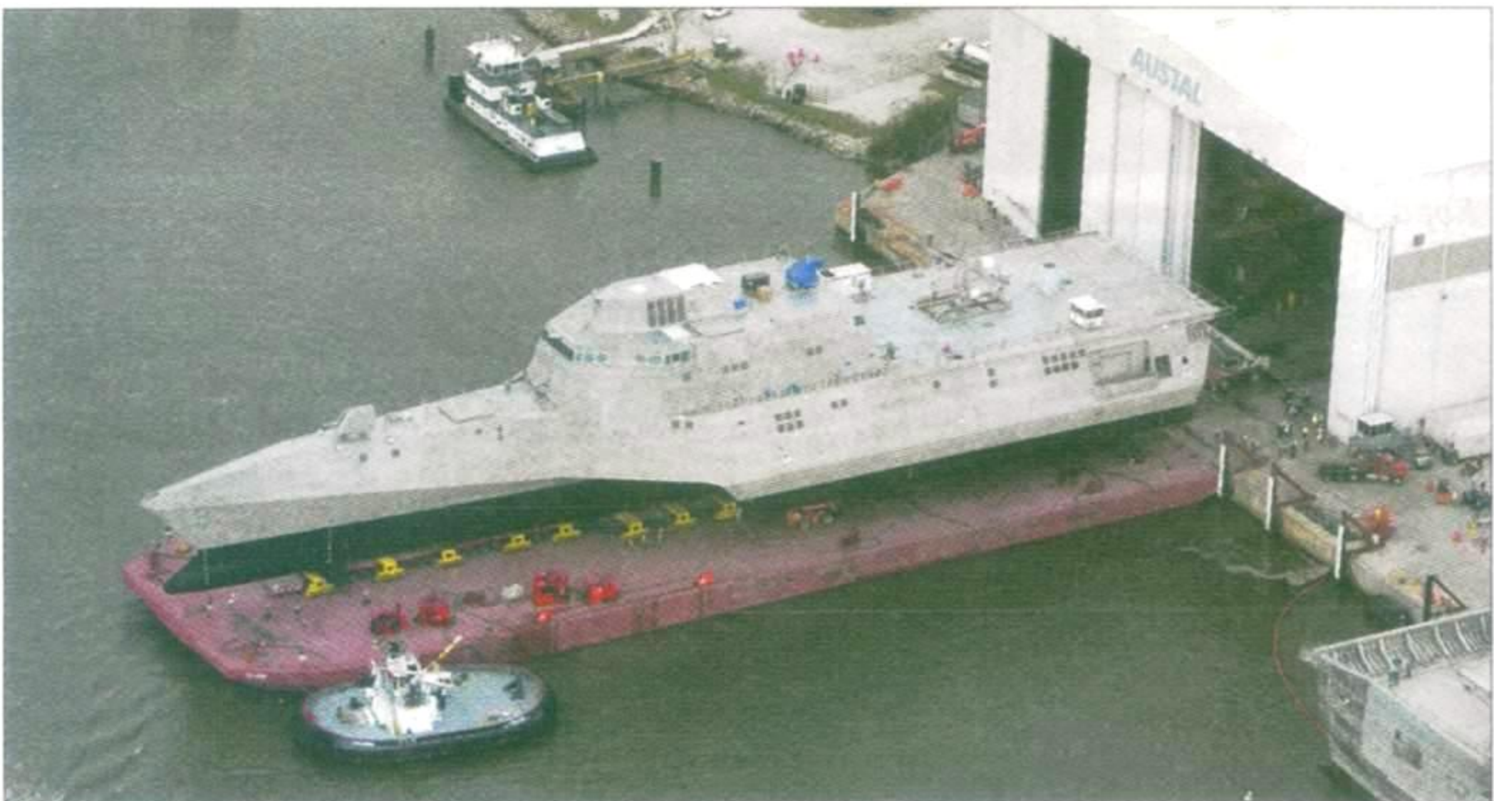
Строительство корабля прибрежной морской зоны LCS-4 «Коронадо» типа «Индепенденс» на верфи «Аустал» корпорации «Дженерал дайнзмикс»
