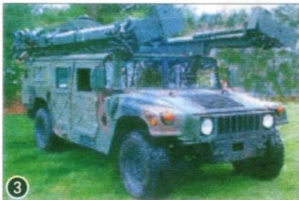
Комплекс оптоэлектронной разведки «Рейд»: 1 – оптоэлектронный блок станции разведки и целеуказания «Стар Сафир-HD»; 2 – мобильная разборная мачта с установленным в верхней части оптоэлектронным блоком станции разведки и целеуказания «Стар Сафир-3»; 3 – элементы комплекса в транспортном положении
