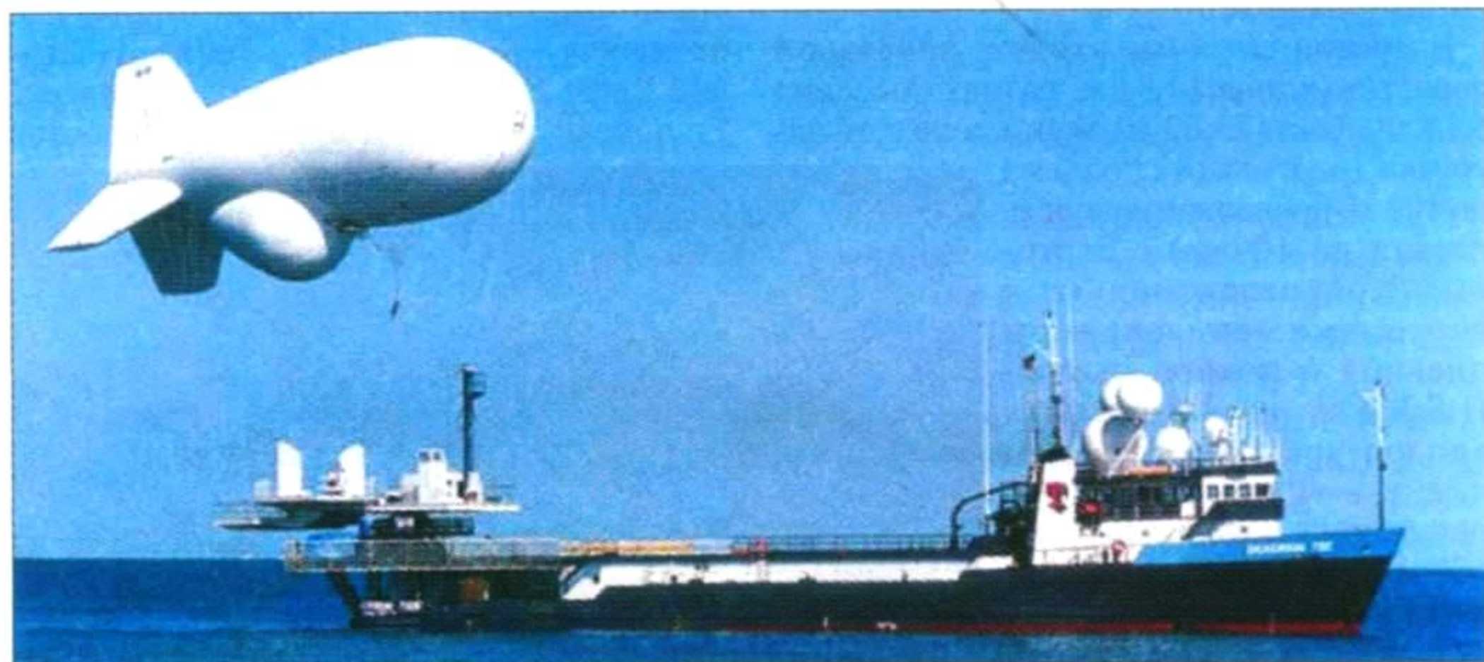
Размещение комплекса оборудования аэростатов 32М/38М на судне
