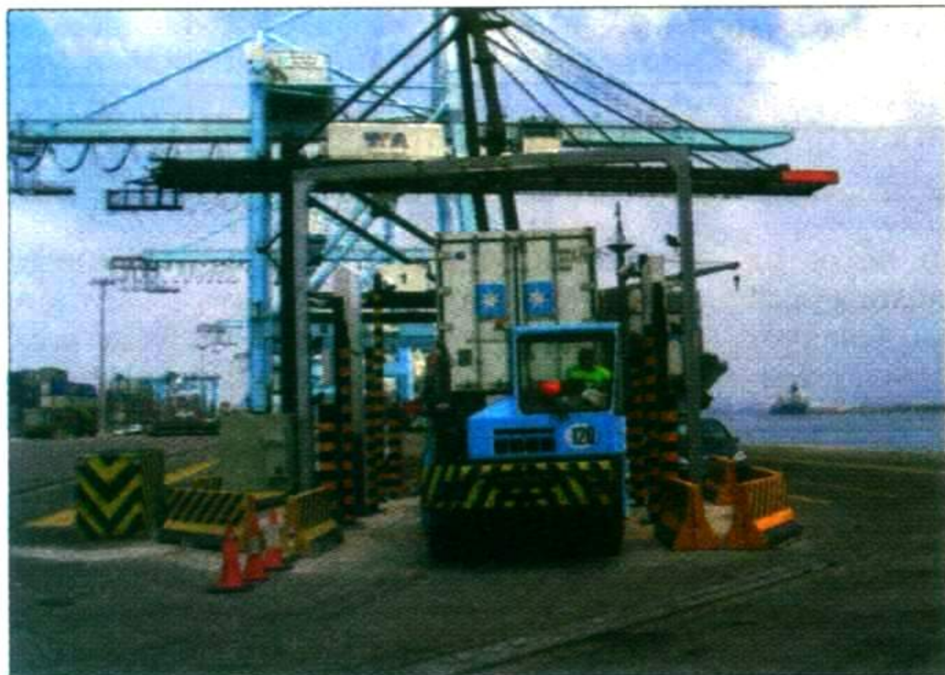
Сканирование контейнера на предмет наличия радиоактивных материалов в морском порту г. Альхесирас (Испания)
